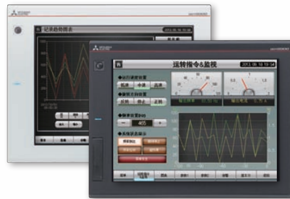
SVGA GT2712-STBA GT2712-STBD GT2712-STWA[白色款] GT2712-STWD[白色款] 分辨率:800×600 显示颜色:65536色
